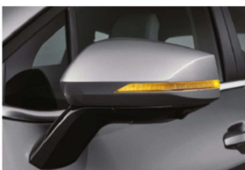
Intermitentes LED integrados en los retrovisores exteriores
