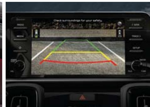
**Monitor de Visión Trasera (RVM)** Cuando la transmisión está en reversa, la pantalla de audio de 8 pulgadas visualiza el área detrás del Sonet, con directrices de estacionamiento superpuestas en la imagen del video.
