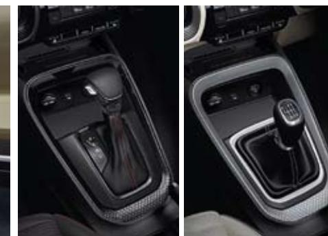
**CVT y transmisión manual de 6 velocidades** El CVT ajusta automáticamente los ratios efectivos con el motor y las condiciones de manejo. La transmisión manual de 6 velocidades le permite cambiar las marchas en forma rápida y precisa.
