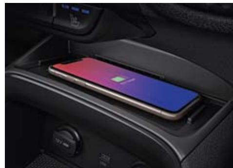
**Cargador inalámbrico de smartphone** Cargue inalámbricamente su teléfono móvil compatible en el panel con función de enfriamiento enfrente de la consola central.
