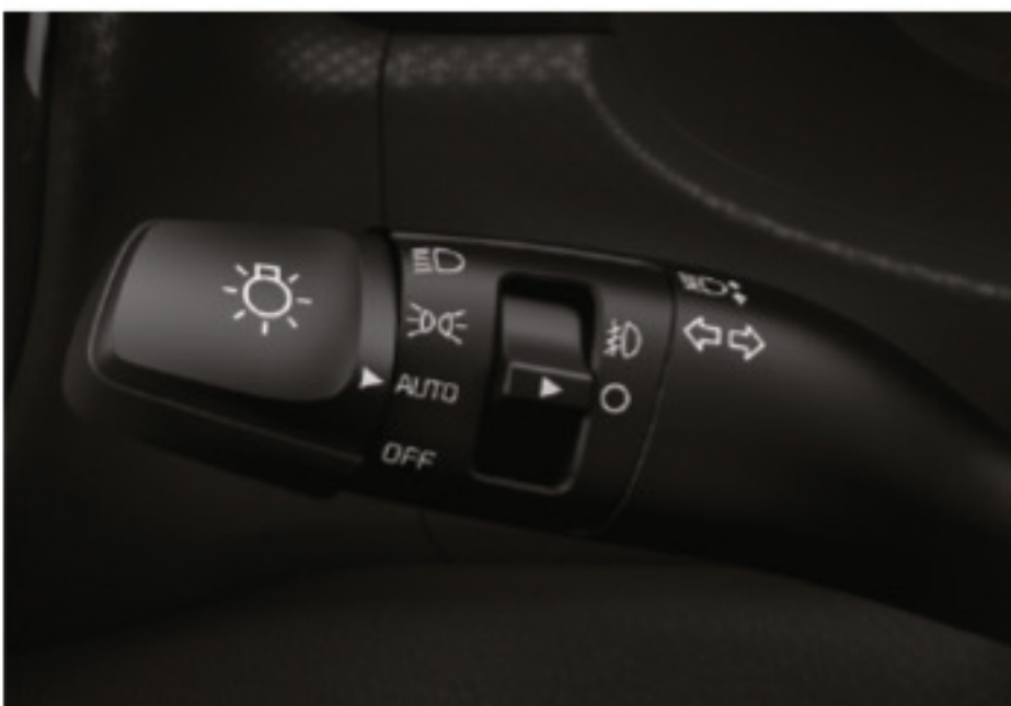
Control automático de luces
